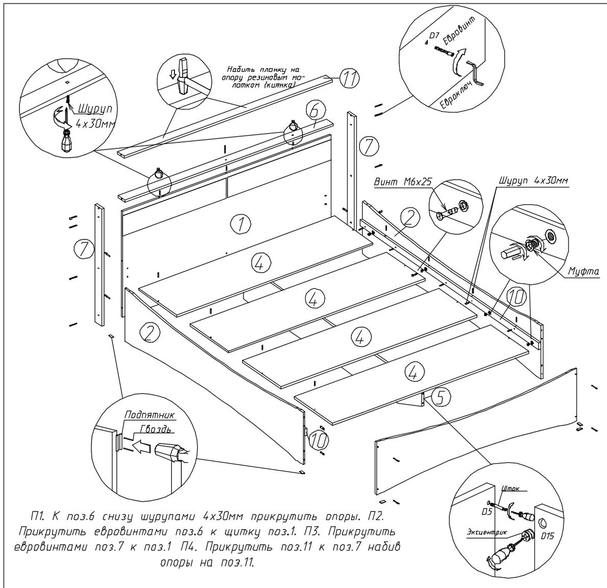
П1. К поз.6 снизу шурупами 4x30мм прикрутить опоры. П2. Прикрутить евровинтами поз.6 к щитку поз.1. П3. Прикрутить евровинтами поз.7 к поз.1. П4. Прикрутить поз.11 к поз.7 надбив опоры на поз.11.
