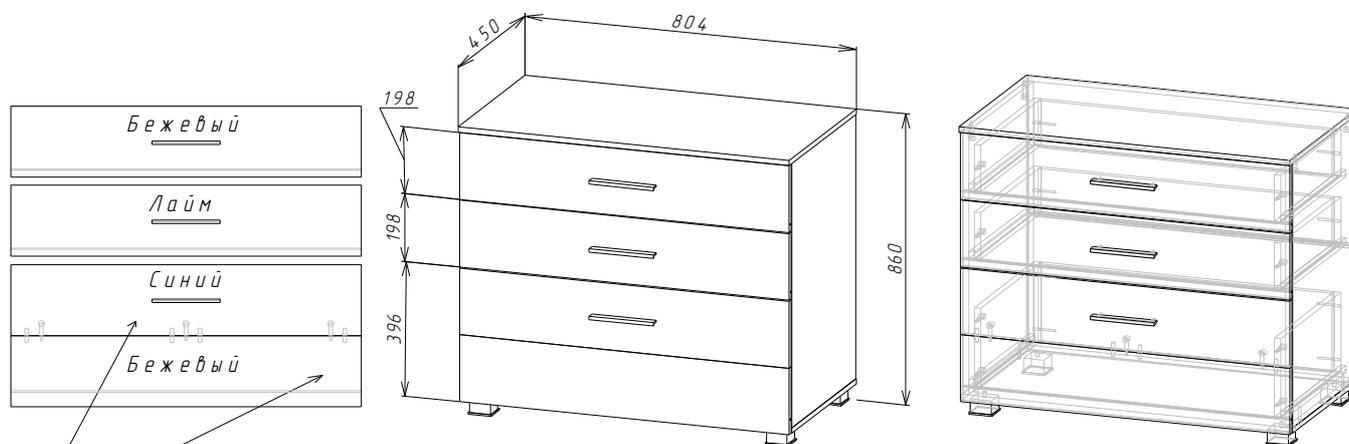
Нижний фасад сборный, состоит из 2 фасадов, собирается с помощью шкантов и эксцентриковой стяжки.
